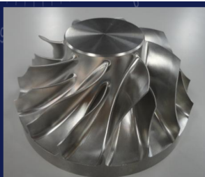
インペラーサンプル サイズ:φ 100mm L50mm 材質:SUS303 先端羽厚み:0.8mm
