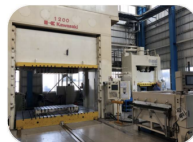
1200t油圧プレス：ベットサイズ3,500×2,500 “金属/樹脂圧縮成形可能”
